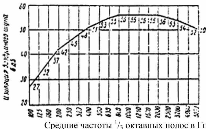
Рис. 6. Нормативная частотная характеристика изоляции воздушного шума ограждающей конструкцией
